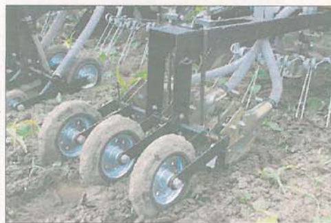
Med det nyudviklede udstyr rillesås frøene, og sådybden styres præcist med et eller to dybdestyringshjul, som styrer såaggregatet.
